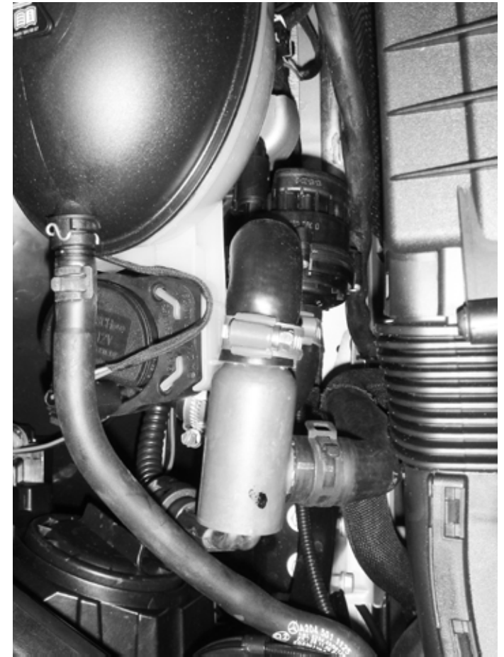
Värmare med slangar monterad. Heater with hoses, mounted. Motorvorwärmer mit montierten Schläuchen.
