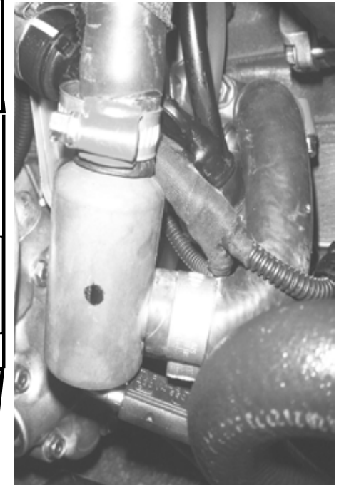
Värmare med slang monterad. Heater with hose, mounted. Motorvorwärmer mit montiert Schläuche.
