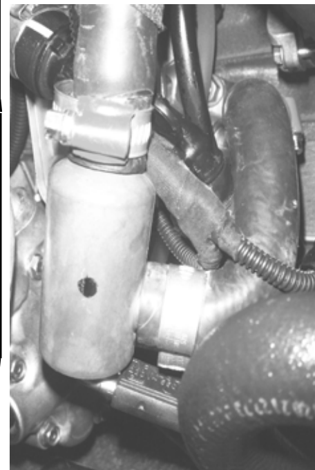
Värmare med slang monterad. Heater with hose, mounted. Motorvorwärmer mit montiert Schläuche.
