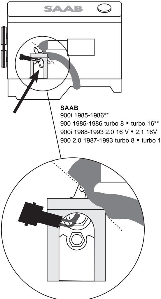
\*\* Är inte bilen utrustad med hydrauliska motorfästen skall värmare 186 användas.
